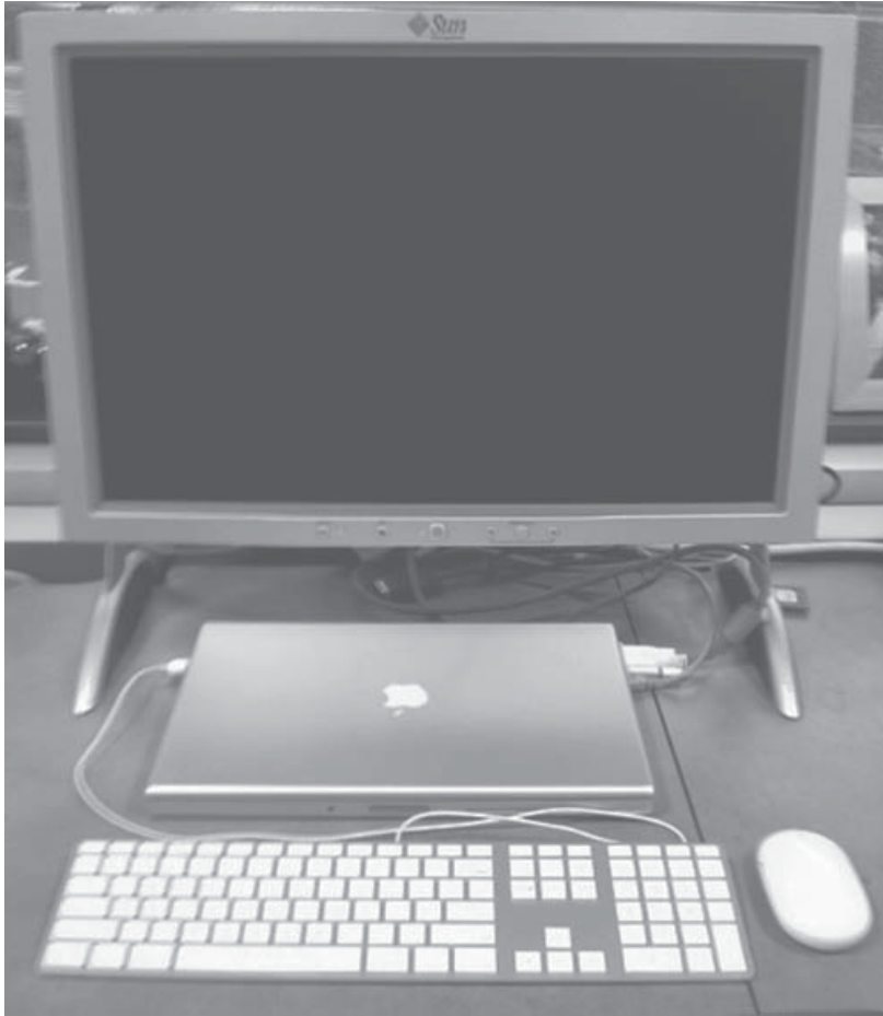
FIGURA 1.5 Un computador de sobremesa. La pantalla de cristal líquido (LCD) es el dispositivo de salida principal, y el teclado y el ratón son los dispositivos de entrada principales. En la parte derecha se puede ver un cable de Ethernet que conecta el portátil con la red y la web. El portátil tiene procesador, memoria y dispositivos de E/S. Este computador es un portátil Macbook Pro 15" conectado a un monitor externo.
