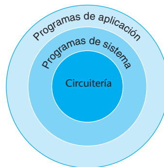
FIGURA 1.2 Vista simplificada del hardware y el software como capas jerárquicas, mostradas como círculos concéntricos con el hardware en el centro y el software de las aplicaciones en el exterior. En aplicaciones complejas frecuentemente se encuentran múltiples capas software. Por ejemplo, un sistema de base de datos puede ejecutarse sobre el software de sistemas que aloja una aplicación, el cual a su vez se ejecuta sobre la base de datos.
