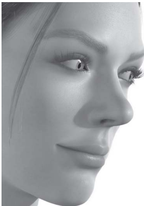
FIGURA A.3.2 Imagen renderizada en una GPU. Para dar profundidad visual y un aspecto traslúcido a la piel, el programa de sombreado de píxel modela tres capas de piel separadas, cada una con un comportamiento diferente de la dispersión ( scattering ) bajo la superficie. Se ejecutan 1400 instrucciones para renderizar los componentes rojo, verde, azul y alfa del color de cada píxel de la piel.
